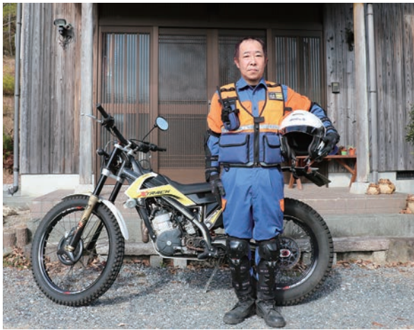
▲スペイン製の排気量250cc トライアルバイク。70kg程度 の軽量ボディで、意のままに 道なき道を突き進む
